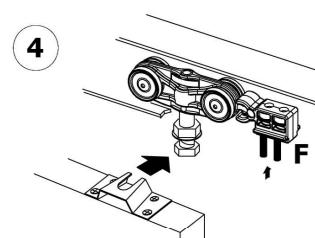
Závesy vložte do drážky vodící kolejnice. Dveře namontujte na závesy a zkонтrolujte posuv. Nasadte plastový doraz "F" na kolejnici. Zkontrolujte pozici dorazu, aby správně vymezoval koncovou polohu zavřených dveří a přišroubujte přiloženými šroubkami.
