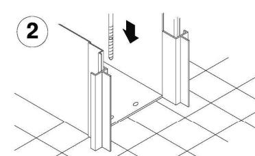
Vrtákem Ø 3 mm předvrťte díry pro upevnění vodícího trnu do podlahy. Upevněte vodící trn k podlaze pomocí přiložených šroubů. Pokud je pouzdro namontované pod úrovní finální podlahy, použijte přiložené distanční podložky. (šíří vodící drážku vymezte natočením trnu v ose dveří)
