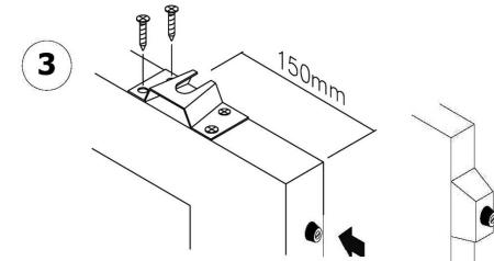
Připevněte konzoly na horní hranu a gumové dorazy na zadní hranu dveří. Pokud chcete, aby dveře vyčnívaly z pouzdra, podložte gumové dorazy distanční podložkou.
